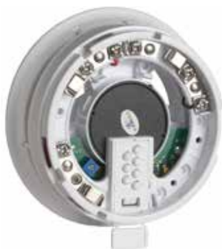
Вспомогательный звуковой оповещатель с базовым основанием ESI-10
